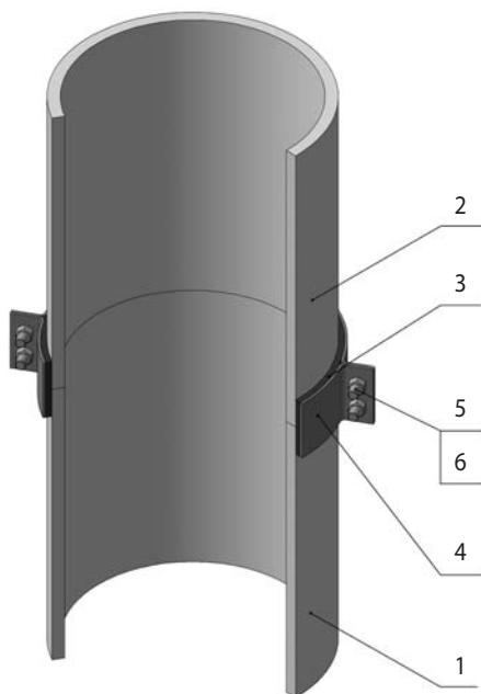
Это один из способов фиксации стыков труб в стволе мусоропровода, выполненного из хризотилцементных безнапорных труб. Для соединения используют металлические хомуты различных конструкций с обязательным применением уплотняющих резиновых прокладок.
