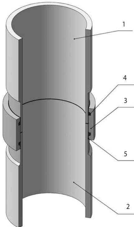
Является традиционным способом соединения труб в стволе мусоропровода, выполненного из хризотилцементных напорных труб. Для соединений используют стандартные хризотилцементные напорные муфты типа САМ соответствующего диаметра с уплотнительными резиновыми кольцами.
