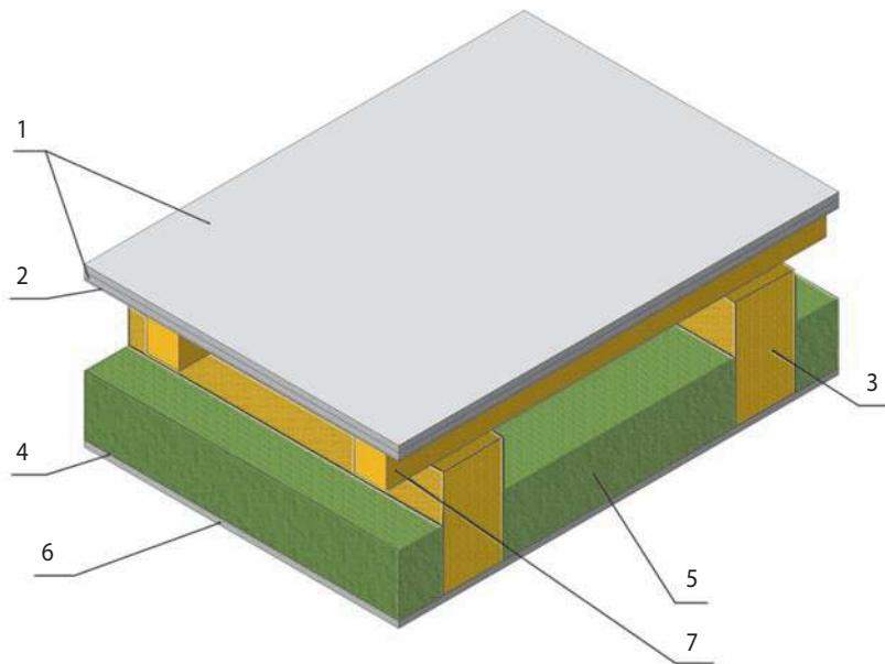
Конструкция межэтажного перекрытия состоит из пола, несущей деревянной балки, межбалочного заполнения, являющегося тепло- и звукоизоляцией, и нижнего настила (он же потолок), поддерживающего слой теплозвукоизоляции.
