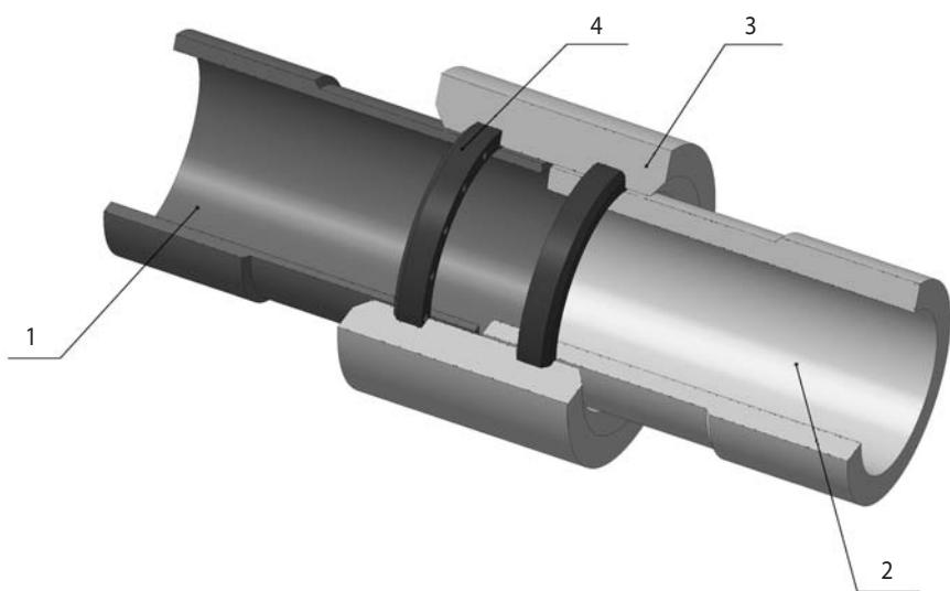
Для данного вида соединения металлической (стальной, чугунной) и хризотилцементной напорной трубы применяется обычная хризотилцементная напорная муфта, работающая по принципу самоуплотнения (тип САМ).
