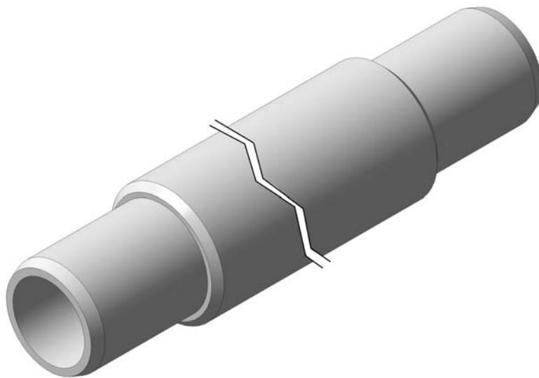
Хризотилцементные напорные трубы производят по ГОСТ (см. стр. 113) и ТУ предприятий. В зависимости от значения рабочего давления транспортируемой жидкости в трубопроводе их разделяют на классы:
