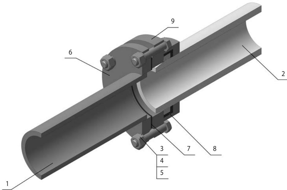
Соединение производится с помощью двух фланцев и резинового кольца, используемого для муфтовых соединений типа САМ хризотилцементных напорных труб. Применяется при монтаже хризотилцементных трубопроводов в местах перехода (отводы, тройники, задвижки) хризотилцементной трубы на металлическую (стальную, чугунную).
