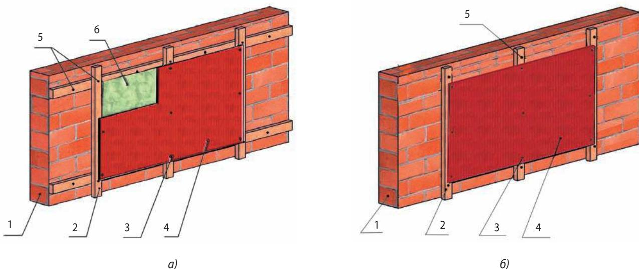
Облицовка фасадов промышленных зданий и домов малоэтажной застройки может выполняться хризотилцементными плоскими прессованными листами (плитами) и мелкоразмерными плитками с утеплителем или без него. Здания приобретают привлекательный внешний вид, решается задача их эффективного утепления. Для облицовки используются как неокрашенные, так и декорированные (окрашенные и с фактурным покрытием) листы.
