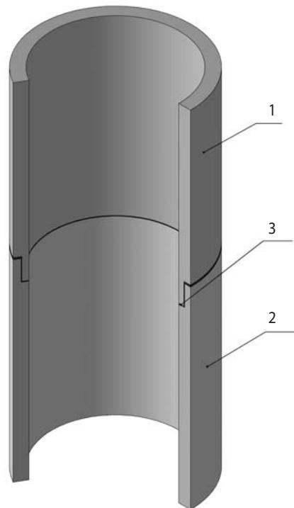
Данный способ соединения применим только для хризотилцементных труб марки ТМ1 400, используемых в системах мусороудаления и вентиляции, изготавляемых по ТУ 5786-005-58801035-2008\*.
