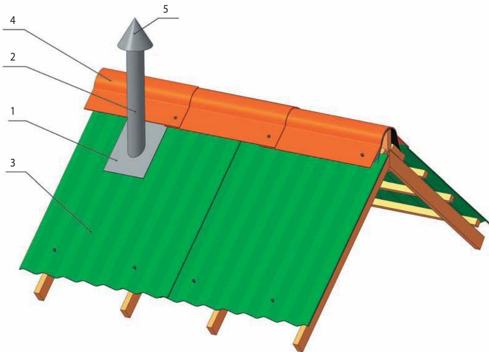
Хризотилцементные трубы используют в качестве дымоходов. Они прочны, легки и не имеют швов. Согласно СНиП 41-01-2003 «Отопление, вентиляция и кондиционирование» для дымоходов из хризотилцементных труб «температура уходящих газов не должна превышать 300 °С». Не допускается применение хризотилцементных дымоходов для печей, работающих на угле.
