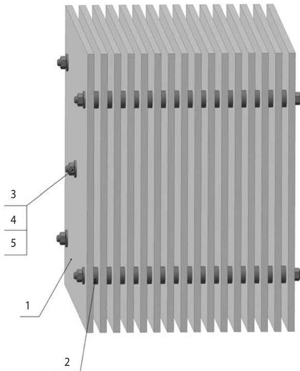
Применение хризотилцементных листов в качестве оросителей градирен рекомендовано СНиП 2.09.03-85 «Сооружения промышленных предприятий» и РД 34.22.402-94 «Типовая инструкция по приемке и эксплуатации башенных градирен».
