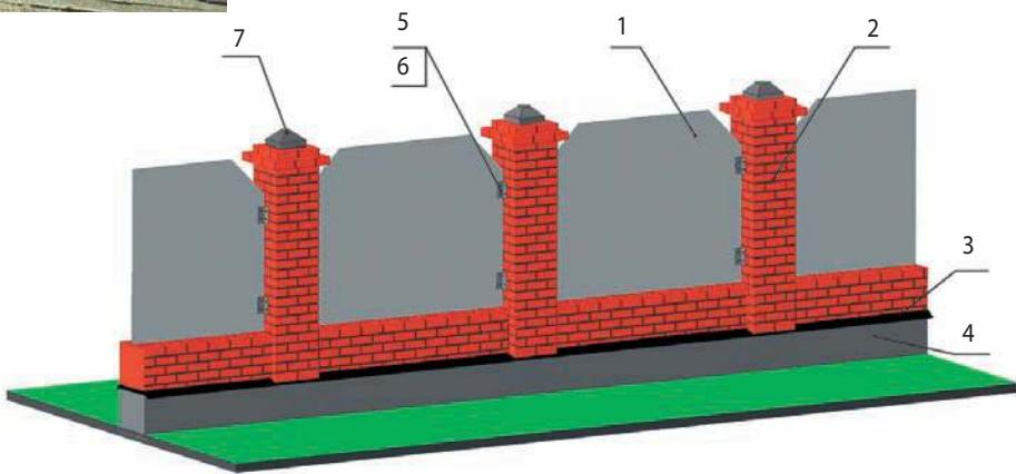
Устройство фундамента под комбинированный забор с кирпичными столбами обязательно. Конструкция фундамента (ленточный или столбчатый) определяется весом и конструкцией забора, а также рельефом местности и характеристиками грунтов в месте его установки.
