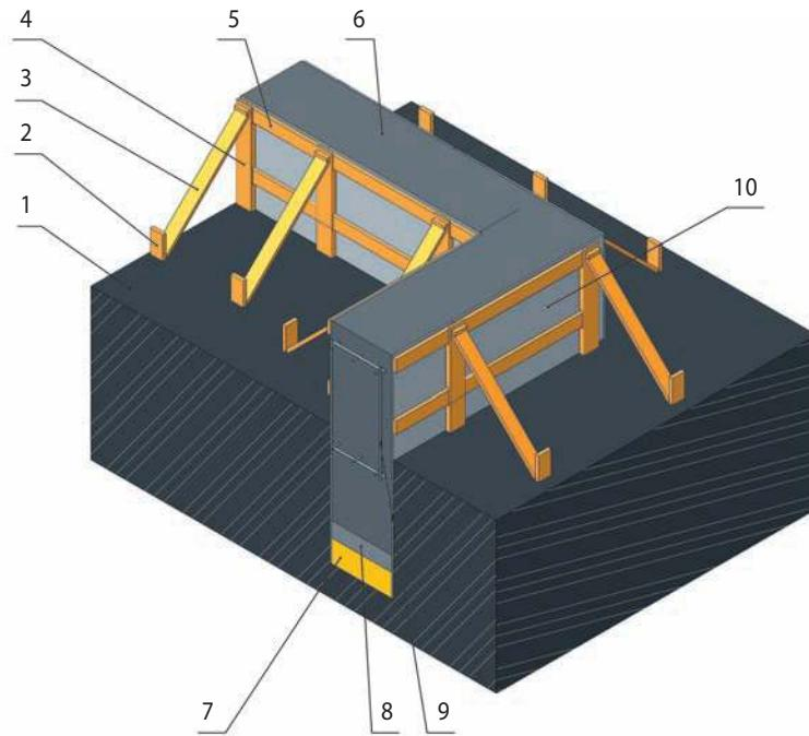
Применяют при строительстве домов с тяжелыми стенами (каменными, бетонными, кирпичными) или с тяжелыми перекрытиями в различных грунтах независимо от их влажности, кроме пучинистых и глубокопромерзающих грунтов. Подошва фундамента располагается ниже глубины промерзания грунта.
