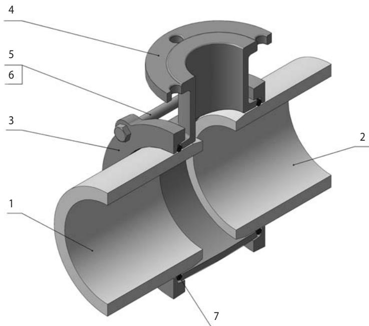
Данный вид соединения осуществляется при помощи чугунных муфт и соединительных деталей, изготавливаемых по ГОСТ 17584-72. Применяется для присоединения хризотилцементных напорных труб к металлическим фланцам арматуры в системах водоснабжения и мелиорации, работающих под давлением до 1,5 МПа. Эти чугунные муфты и детали предназначены также для устройства отводов.
