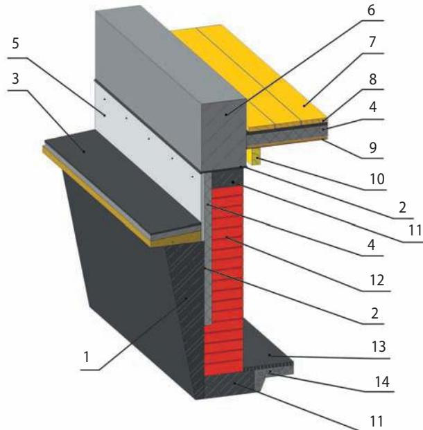
В данной конструкции цоколя, применяемой в сухих непучинистых грунтах, стены подвала выложены из кирпича, а хризотилцементный плоский лист осуществляет функции изоляционной защиты фасада здания и утеплителя, расположенного снаружи. Гидроизоляцию стен подвала выполняют рубероидом или полиэтиленовой пленкой. При таком решении стены подвала не промерзают и не отсыревают. Во влагонасыщенных, пучинистых грунтах стены подвала делают из монолитного бетона и железобетона.
