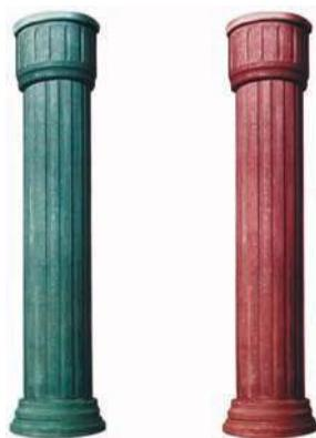
Колонны изготавливают длиной до 5000 мм, диаметром 150–500 мм с фигурными утолщениями вверху и внизу. Заполненные песком или бетоном, они используются как несущие конструкции. Пустотелые (пустотельные) колонны применяются в качестве декоративных дополнений при устройстве входов в здания, балконов, павильонов и беседок, стоек для навесов любого назначения и т. п. Хризотилцементные колонны можно окрашивать красками на основе акриловых смол различной цветовой гаммы.
